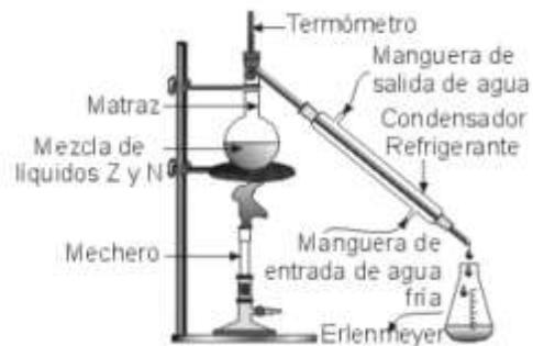
Como se muestra en el dibujo, al condensador se encuentran conectadas dos mangueras por las cuales se hace circular agua fría. Debido a esta corriente de agua, se logra que la temperatura en el condensador sea diferente de la
